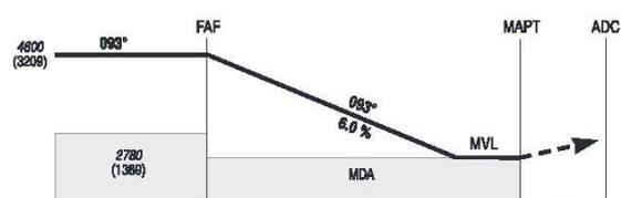
API : Au MAPT tourner à droite RM 273° (IAS MAX 160 kt) en montée. A 4600 (3209) tourner à droite vers ADC en montée vers 5000 (3609) pour intégrer l'attente ADC.
